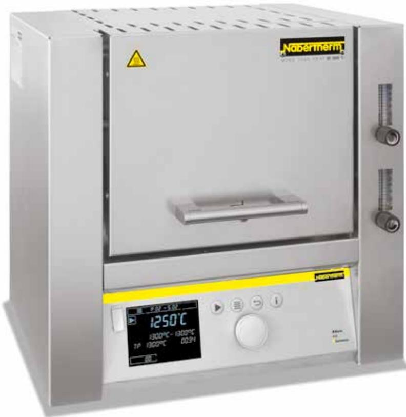
Der Sinterofen LT 02/13 CR wird für das Sintern von Kobalt-Chrom-Restaurationen eingesetzt. Das Sintergut wird in eine spezielle Sinterglocke eingelegt und unter Argon wärmebehandelt. Gute Sinterergebnisse in einer fast sauerstofffreien Atmosphäre bei geringem Argonverbrauch werden durch die besondere Bauweise in Kombination mit Sinterperlen erzielt.
